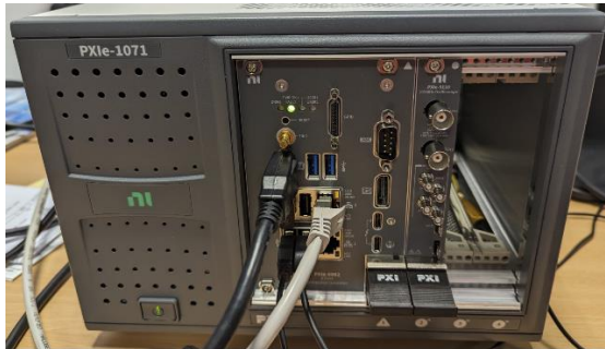
Rysunek 23 Sterownik NI PXI wykorzystany do rejestracji prądu i napięcia oraz fragment kodu źródłowego aplikacji akwizycji danych
