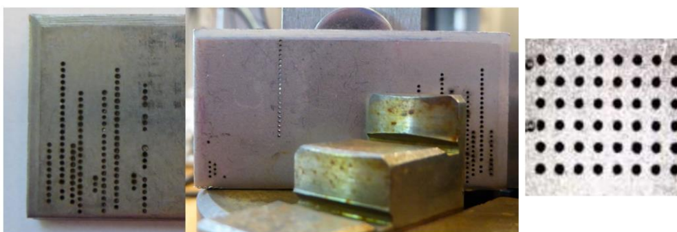
Rysunek 28 Przykładowe płytki Incolen718 po wierszowym drążeniu otworów w procesie FHD
