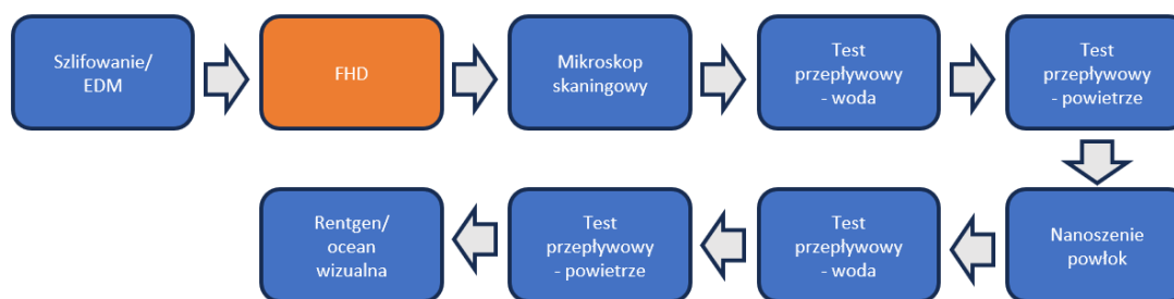
Rysunek 12 Schemat procesu produkcji części wymagających drążenia FHD
